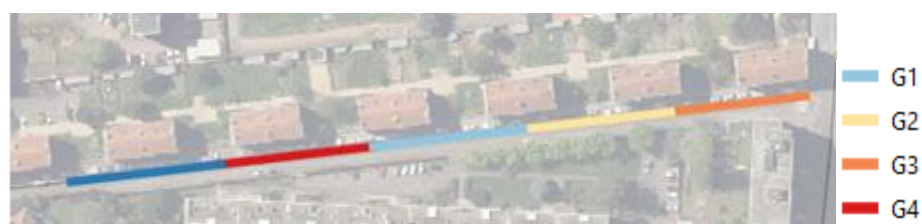
Figure 23 Non uniformité des codes Indigau le long d'une canalisation
